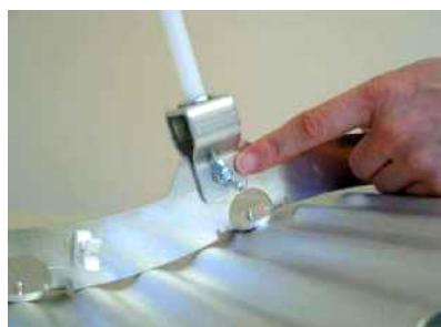
Křídlovou maticí fixujte GeoWave ve vodorovné poloze. Dbejte na to, aby nedošlo k ohrožení osob, např. nárazem do hlavy při příliš nízkém zavěšení.
